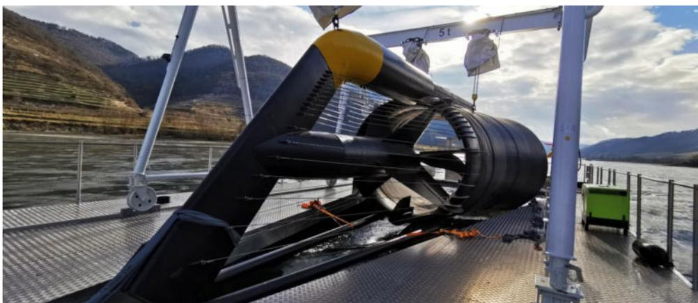
Abbildung 38: Flusskraftwerk / Stromboje der Firma Aqua Libre. Quelle: (Aqua Libre 202).
